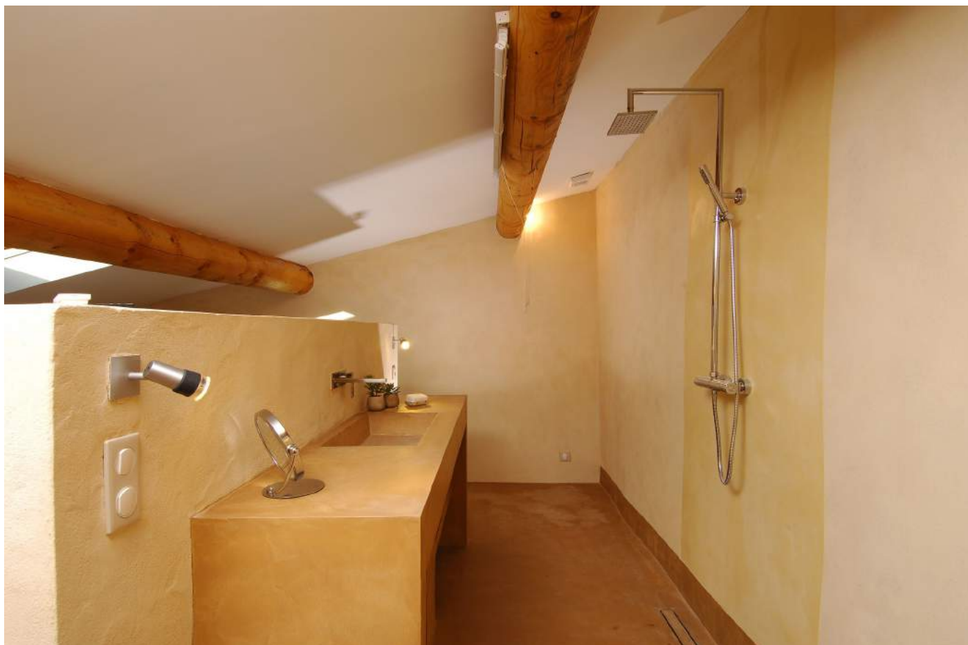
En haut salle d'eau entièrement revêtue de micro-béton dans différents tons de Ocre; en bas, salle de bains complète en béton ciré blanc : mobilier, sol, murs et douche à l'italienne
